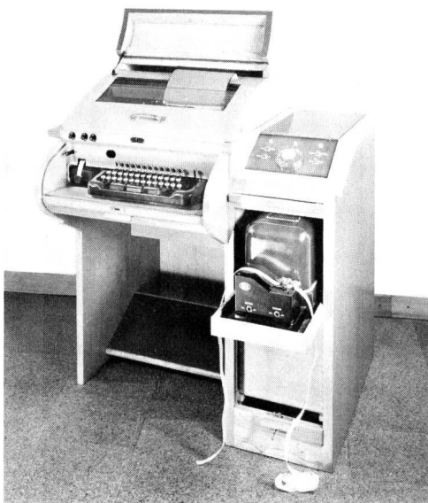
Fig. 3 Siemens-Blattdrucker (Pultstation) mit Lorenz-Lochstreifensender und Wähleinrichtung für Telex – Imprimeur à page de Siemens (exécution en pupitre) avec émetteur à bande perforée de Lorenz et dispositif de sélection pour télex
