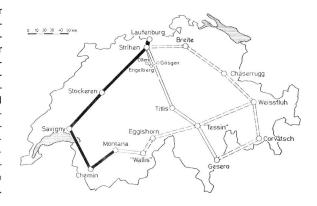
Basisnetz für die Richtstrahlverbindungen der Elektrizitätswerke
