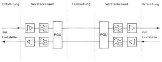
Fig. 2 Leitungsausrüstungen für Datenübertragung mit 48 kbit/s
