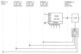
Fig. 4 Datenmultiplexer, basierend auf PCM-System (2,048 Mbit/s
