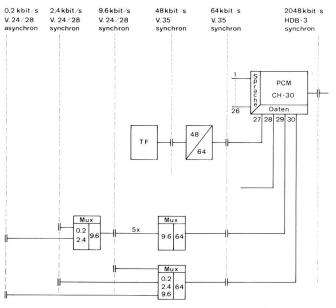
Fig. 3 Datenmultiplexer, basierend auf PCM-Zeitschlitz (64 kbit/s)
