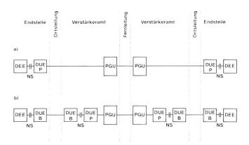
Fig. 1 Aufbau von Breitbandverbindungen mit 48 kbit/s
