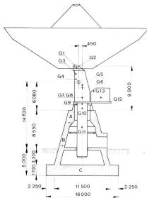
Distribution of antenna weight — Répartition des charges sur l'antenne
