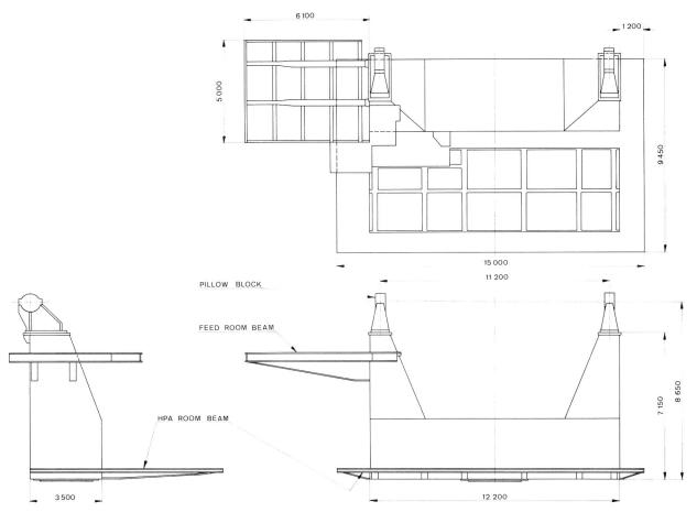
Fig. 4 Yoke assembly — Montage du joug
