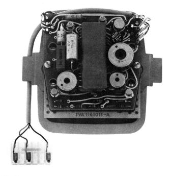
Fig. 11 Tastiera TE 70 P per selezione ad impulsi
