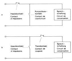
Fig. 8a Disposizione dei contatti di selezione nell'apparecchio con disco
