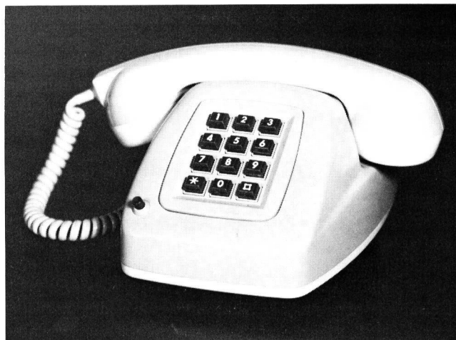
Fig. 5 Telefonapparat Modell 70 mit Tastatur – Poste téléphonique modèle 70 avec clavier de sélection
