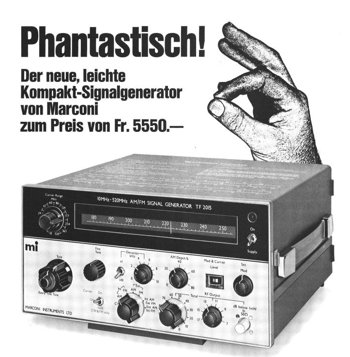
Der neue TF 2015 ist wirklich einzigartig: Ein Signalgenerator mit einem Frequenzbereich von 10 Hz—520 MHz in der Grösse  $28,5 \times 31 \times 14$  cm, der nur 5,4 kg wiegt. Seine Ausgangsspannung ist konstant in allen Bereichen. Die Ablesgenauigkeit beträgt 0,2 dB, die absolute Genauigkeit  $\pm$  1 dB.
