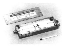
Fig. 3 Amplificateur à hyperfréquences travaillant dans la plage de fréquences comprises entre 1 et 1,5 GHz
