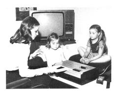
Fig. 12 TED-Bildplattenspieler Durch den Schlitz wird die Bildplatte mit ihrer Hülle eingeschoben.
