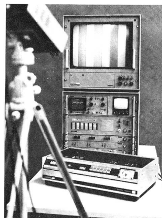
Fig. 10 Spectra-Colorvision CCS, audiovisuelles System für die elektronische Abtastung und Wiedergabe von (kassettierten) Super-8-Filmen
