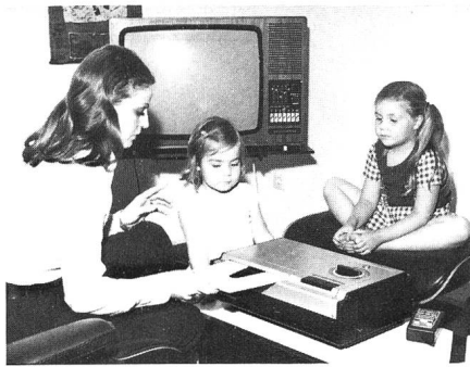
Fig. 12 TED-Bildplattenspieler Durch den Schlitz wird die Bildplatte mit ihrer Hülle eingeschoben.
