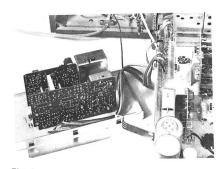
Fig. 6 Secam-Baustein. Ergänzt durch den Pal-Farbbaustein, wird an der freigewordenen Kontaktleiste ins Chassis eingesetzt
