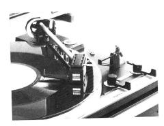
Fig. 16 MDR-Bildplatte mit innenliegenden Führungsrillen und aussenliegendem magnetisierbarem Teil. Der die Magnetspuren abtastende Magnetkopf enthält einen Vorverstärker und wird von einem Ausleger geführt
