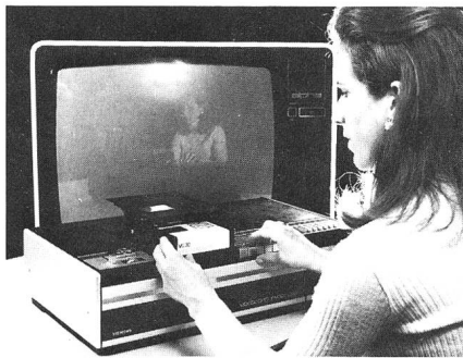
Fig. 9 VCR-Bandaufzeichnungs- und -wiedergabegerät mit eigenem Fernseh-Empfangsteil. Das Bild zeigt das Einlegen der VCR-Kassette
