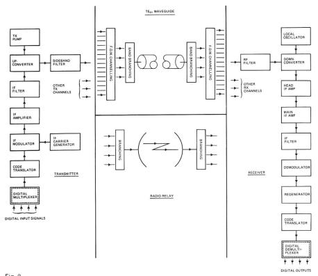
Schéma synoptique du système à guide d'ondes expérimental qui sera soumis aux essais par les Postes et Téléphones britanniques. La figure représente aussi le matériel nécessaire pour un relais hertzien. A noter: la proportion du matériel qui est commune aux deux systèmes.
