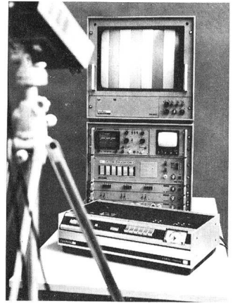
Fig. 10 Spectra-Colorvision CCS, audiovisuelles System für die elektronische Abtastung und Wiedergabe von (kassettierten) Super-8-Filmen
