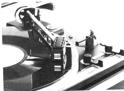
Fig. 16 MDR-Bildplatte mit innenliegenden Führungsrillen und aussenliegendem magnetisierbarem Teil. Der die Magnetspuren abtastende Magnetkopf enthält einen Vorverstärker und wird von einem Ausleger geführt
