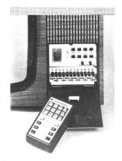
Fig. 3 Ultraschall-Fernsteuerung mit 12 gezielt anwählbaren Stationstasten. Die Voreinsteller sind hinter einer Klappe geschützt
