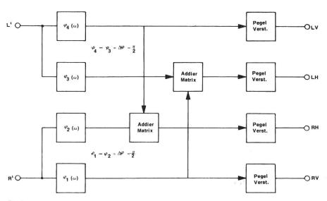
Fig. 6 Funktion des Matrix-Decoders beim «SQ»-System (4-2-4) – Fonctionnement du décodeur matriciel dans le système «SQ» (4-2-4)
