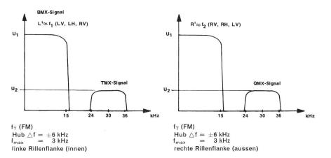
Signalverteilung beim «UMX»-System für wahlweise 4-2-4 (BMX), 4-3-4 (TMX) oder 4-4-4 (QMX) Decodierung – Répartition des signaux dans le système «UMX» pour décodage 4-2-4 (BMX), 4-3-4 (TMX) ou 4-4-4 (QMX)
