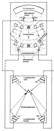
Prinzip der «diskreten» Quadro-Übertragung Principe de la transmission quadrophonique «discrète»
