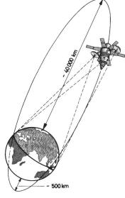
Fig. 2 Die elliptische Umlaufbahn der Molnija-Satelliten weist über der Sowjetunion ein ausgeprägtes Apogäum von rund 40 000 km auf
