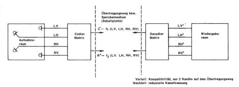
Fig. 3 Prinzip der Matrix-Codierung von vier Quadrosignalen auf zwei Übertragungs- beziehungsweise Speicherkanäle – Principe du codage matriciel de quatre signaux quadrophoniques sur deux canaux de transmission ou d'enregistrement
