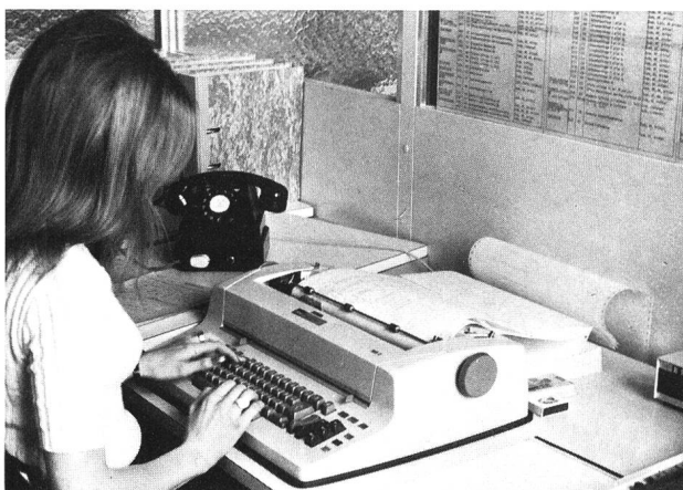
Fig. 17 Machine à écrire Terminal IBM 2740 de la section de la gestion des magasins (FM 2)
