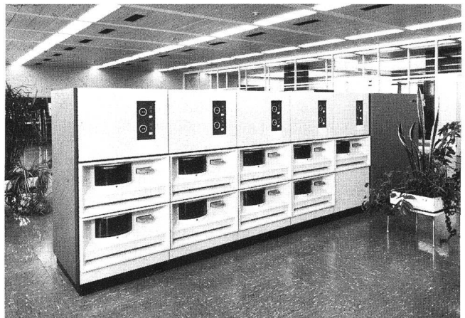
Fig. 16 Mémoire à disque de grande capacité IBM 2314 ; 4 des 9 unités (env. 120 mio de bytes) sont utilisées par le MATICO FM
