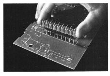
Fig. 3 Oben: Nagel und Feder, die Grundelemente des Steckkontakts. Unten: Platine mit Nagelreihe und Steckerleiste
