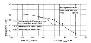
Fig. 18 NF-Störabstand in Abhängigkeit des ZF-Störabstandes
