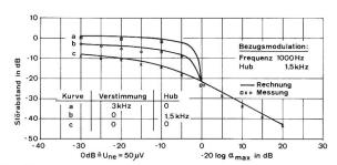
Fig. 15 NF-Störabstand in Abhängigkeit des ZF-Störabstandes
