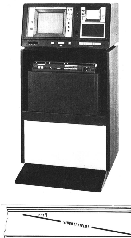
Fig. 7 Bildaufzeichnungsgerät BCR von Philips/Bosch-Fernseh-GmbH mit Schrägspur-Videoaufzeichnung, zwei Längs-Tonspuren (1. und 3. oben) sowie zwei Hilfsspuren (2. oben und unten) auf 1-Zoll-Band – Appareil d'enregistrement vidéo sur bande 1 pouce BCR de Philips/Bosch-Fernseh S. à r. l., avec enregistrement vidéo sur piste oblique, 2 pistes son longitudinales (1 et 3 en haut) et 2 pistes auxiliaires (la 2 e en haut et celle du bas)
