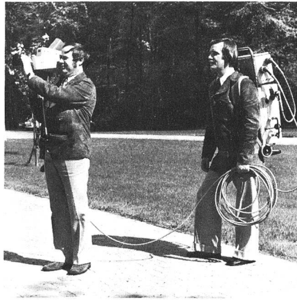
Fig. 3 Leichte Reporter-Farbfernsehkamera für Netz- oder Batteriebetrieb (Bosch-Fernseh-GmbH) – Caméra légère pour reportages de télévision en couleur, exploitation sur réseau ou batteries (Bosch-Fernseh-S. à r. l.)
