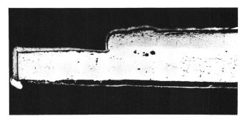
Fig. 7 Micrographie longitudinale d'une soudobrasure de tungstène et de molybdène avec apport de platine
