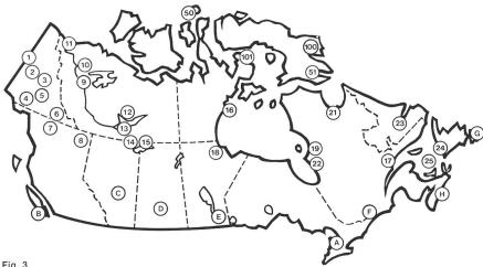
Das Basisnetz der kanadischen Bodenstationen. Es umrasst Stationen für starken Fernverkehr (A, B), den Austausch von Fernsehprogrammen zwischen den Hauptzentren im Süden des Landes (C...H), Empfangsstationen im Norden für Fernsehprogramme (1...25), Stationen für den Fernmeldeverkehr mit Kanadas Norden (50, 51), die ebenfalls für TV-Empfang eingerichtet sind, und schliesslich vorerst zwei Schwachverkehrsstationen (100, 101), ferner eine Leitstation (A)
