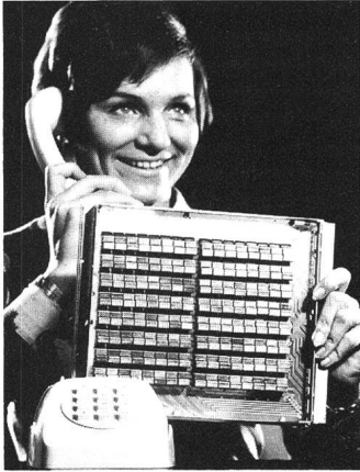
Fig. 1 Sprechverbindungen werden im EWS 1-Koppelnetz mit miniaturisierten, bistabilen Relais durchgeschaltet, die auf steckbaren Baugruppen untergebracht sind. Eine solche Baugruppe des Koppelnetzes enthält 128 Koppelpunkte mit je zwei Schutzgaskontakten in Metallgehäuse
