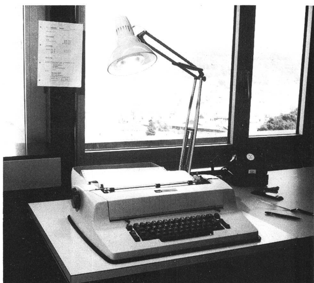
Fig. 1 Die Datenstation (Terminal) IBM 2741. Schreibgeschwindigkeit etwa 15 Zeichen/s
