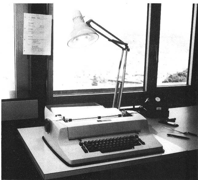
Fig. 1 Die Datenstation (Terminal) IBM 2741. Schreibgeschwindigkeit etwa 15 Zeichen/s
