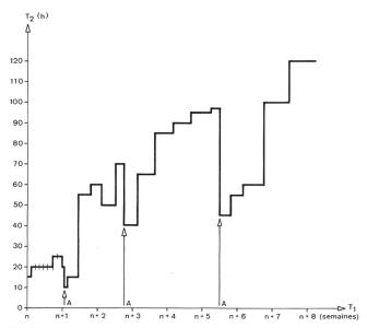
Fig. 1 Evolution type de la fiabilité software en fonction de la durée des essais
