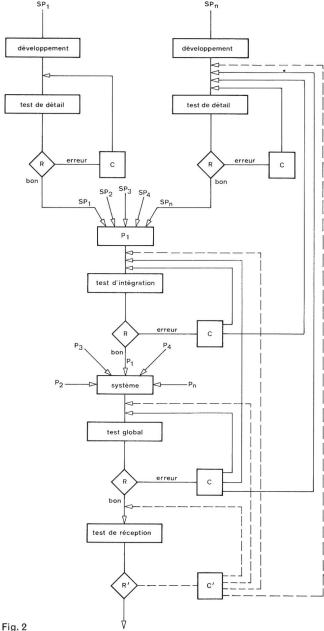
Procédures de régression en cas de découverte d'erreurs au cours des différentes phases de test
