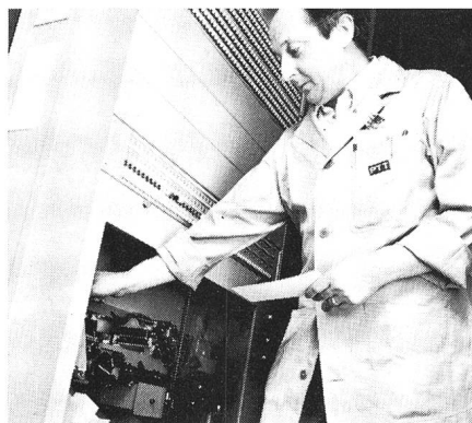
Der PTT-Fernmeldespezialist entnimmt dem Stanzer die Lochkarte
