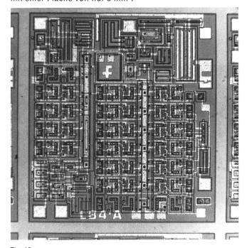
Fig. 18 Vollständig integrierte Schaltung für Grossuhren (SAJ 250)
