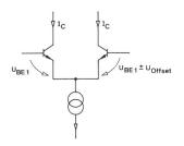
Fig. 8 Differentialstufe
