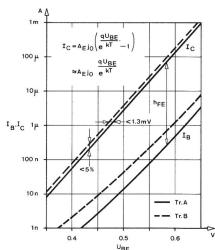
Kennlinie, das heisst Kollektorströme und Basisströme in Funktion der Basis-Emitter-Spannung von zwei benachbarten integrierten Transistoren
