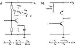
Konventionelle, wechselstrom-gekoppelte Verstärkerstufe
