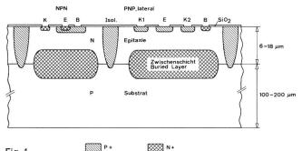
Querschnitt, 4fach überhöht, durch einen integrierten NPN- und lateralen PNP-Transistor
