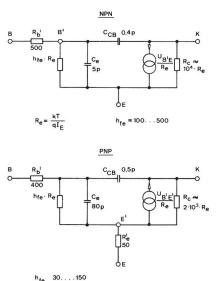
Fig. 3  $h_{\rm fe}$  30....150  $\pi$ -Ersatzschaltbilder von integrierten Transistoren
