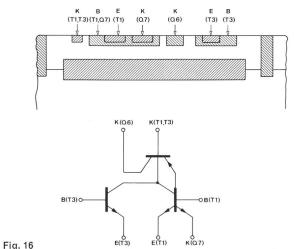
Schematischer Querschnitt durch die Halbstufe der Figur 15 und entsprechendes Symbol
