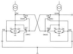
Ersatzschaltbild eines integrierbaren, wechselstrom-gekoppelten Trigger-Flip-Flops
