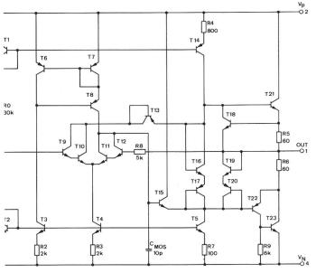
Fig. 10 Schaltbild des Spannungsfolgers TCA 410
