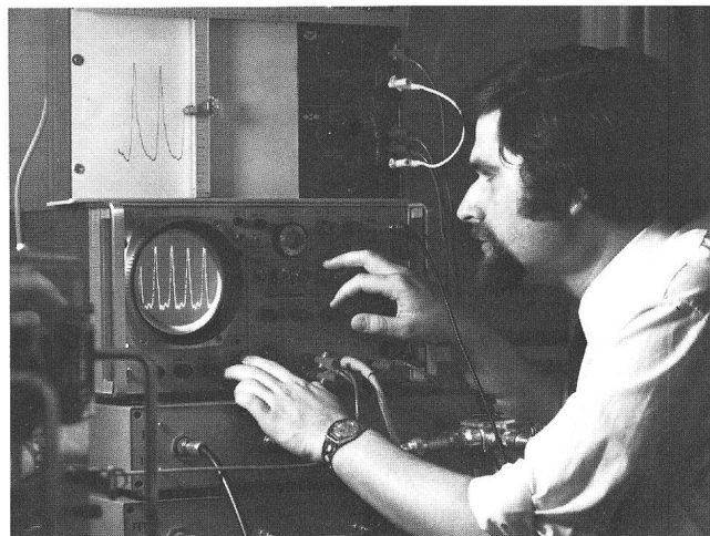
Fig. 2 Modulation eines Doppelheterostruktur-Injektionslasers mit 500 Mbit/s
