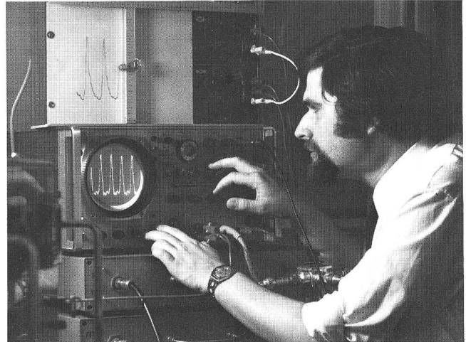
Fig. 2 Modulation eines Doppelheterostruktur-Injektionslasers mit 500 Mbit/s
