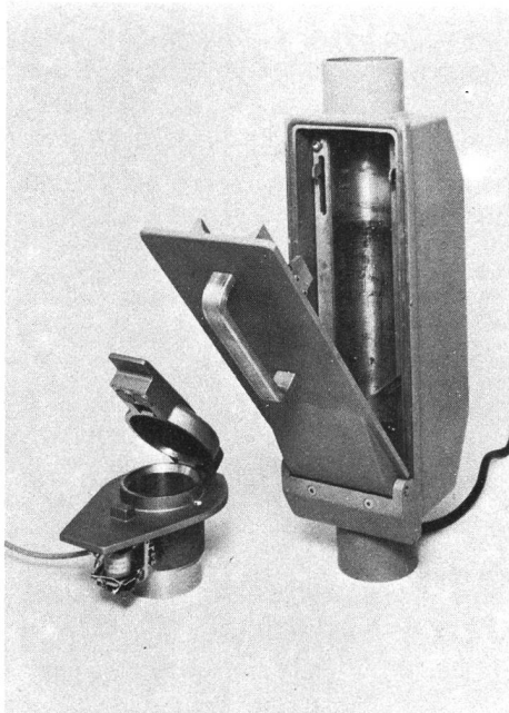
Fig. 7 Links Topf-, rechts Zwischensender der NW 65 mm für automatische Stadt- und Hausrohrposten der schweizerischen PTT-Betriebe – A gauche: bouche d'envoi; à droite: expéditeur intermédiaire à diamètre intérieur de 65 mm pour installations automatiques urbaines et internes de l'Entreprise des PTT suisses
