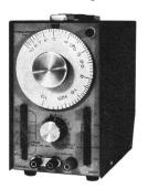
Frequenzbereich: Frequenzstabilität: 10 Hz bis 1 MHz kurzzeitig 0,2 %
