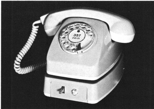
Fig. 9 Tischapparat und Untersatzkasten mit Umschalteschlüssel und Schauzeichen – Poste téléphonique de table et boîte accessoire avec clef de commutation et voyant
