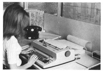
Fig. 17 Schreibmaschinen-Terminal IBM 2740 bei der Sektion Lagerwirtschaft
