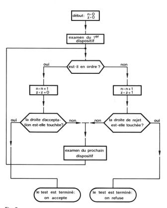
Diagramme fonctionnel expliquant le déroulement du test
