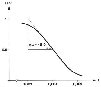
Fig. 9 Probabilité d'acceptation en fonction de la fréquence de défaillances Exemple 1  $\alpha = \beta = 0.1$  $p_o = 0.003$
