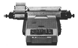
Der dielektrische Lochstreifen-Schnelleser FACIT 4001 wird an verschiedene Computer angeschlossen und erlaubt die rationelle Verarbeitung der Daten im On-Line-Betrieb, oder die Lochstreifen werden durch eines der zahlreichen Service-Büros verarbeitet.
