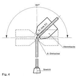
Prinzip der Biegeprüfeinrichtung Principio dell'impianto di prova per le piegature
