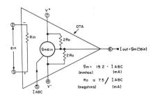
Der OTA ist ein Operationsverstärker, dessen Ausgangsstrom eine lineare Funktion der differentiellen Eingangsspannung ist, wobei die Signalverstärkung mit Hilfe des Biasstrom-Einganges in einem sehr grossen Bereich variiert werden kann.
