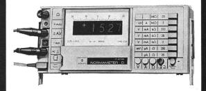
Digitale und analoge Anzeige Ziffernfolge 0...1999 Überlastschutz Automatische Polaritätsanzeige Drucker- und Schreiberausgang Für Gleich- und Wechselspannung, Gleich- und Wechselstrom, Widerstand
