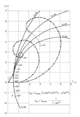
Fig. 10 Reflexions verlauf eines Abschwächers mit normierter Einzelreflexion r=1
