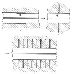
Fig. 5 Streifenteilerspannungsteiler
