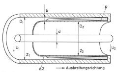
Fig. 2 Koaxialer Spannungsteiler
