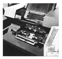
Fig. 1a Alte Version der Karteneinlesung. Defekte Einzahlungskarten verursachen lange Stillegungszeiten
