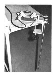
Fig. 2 Haltevorrichtung für die zu messenden Kondensatoren
