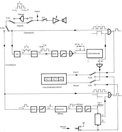
Fig. 1 Blockschema des Impulsmessgerätes
