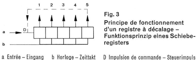
(fig. 2). L'angle supérieur gauche de la fenêtre où apparaissent les caractères étant fixé, il faut pouvoir définir la position de chaque point d'une lettre. A cet effet, il y a lieu de produire des séries de cinq impulsions (1...5), revenant tous les 8 points (5 points pour la lettre, 3 pour l'espace.) Cela est réalisé par le truchement de registres à décalage, éléments logiques, dont le fonctionnement est en bref le suivant: C'est une suite de circuits flip-flop, commandés
