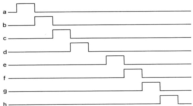
mation, die dem ersten Glied der Kette zugeführt wird, an die folgenden Glieder weitergeben. Auf diese Weise kann man das Ausgangssignal wieder dem Eingang zuführen und es so dauernd umlaufen lassen (Fig. 3).
