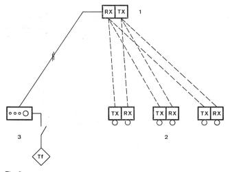
Fig. 3 Schéma synoptique d'un réseau duplex
