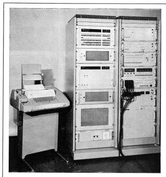
Ortsfester Kabelmessautomat «Rekamat» mit elektronischem Digitalrechner Hersteller: Felten & Guilleaume Kabelwerke AG Köln – Mülheim
