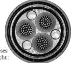
Ein Dreileiter-Oelkabel für 60 000 Volt, geeignet zur Verlegung unter Wasser
