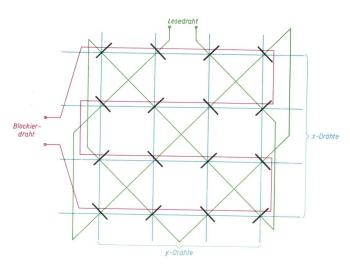
▲ Fig. 20 Drahtführung einer Speichermatrix
