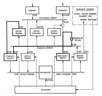
Fig. 25 Blockschaltbild der Programmsteuerung
