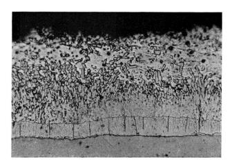
Fig. 16 Verzinkerei A, Kanaltyp Nr. 9, handgetaucht, 5...10 min, 455 °C: Gut ausgebildete Legierungsschicht von normaler Struktur. Die Legierungsschichten nehmen  $\frac{1}{2}$ ... $\frac{2}{3}$  der Gesamtschichtdicke ein
