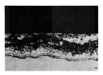
Fig. 32 Verzinkungsversuch: Stahl 33, Tauchtemperatur 460...470 °C, nach dem Verzinken bei 300 °C während 1 Stunde gelagert, Tauchzeit 1 min
