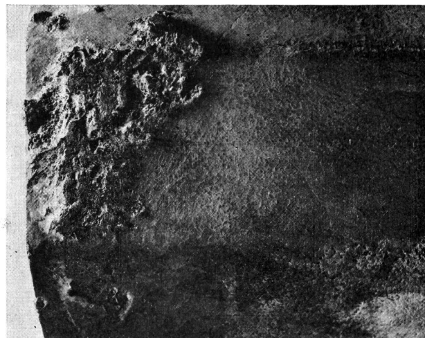
Fig. 6 Kanaltyp Nr. 9: Starke Zinkanhäufung an der Aussenseite eines Kanalendes behindert das Zusammenbrücken
