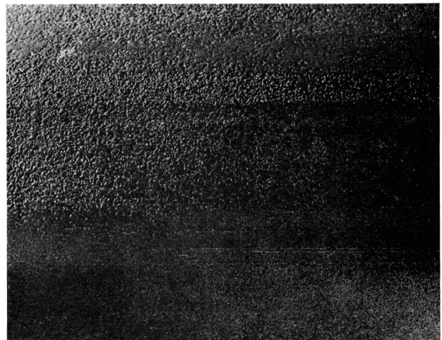
Fig. 10 Kanaltyp Nr. 8: Die graue und porige Verzinkung von über 300 \mu\text{m} Dicke splittert bei Schlageinwirkung ab
