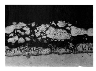
Fig. 31 Verzinkerei D, 1969, Kanallyp Nr. 9: Querschnitt durch einen grau gestreiften, schlecht haftenden Überzug
