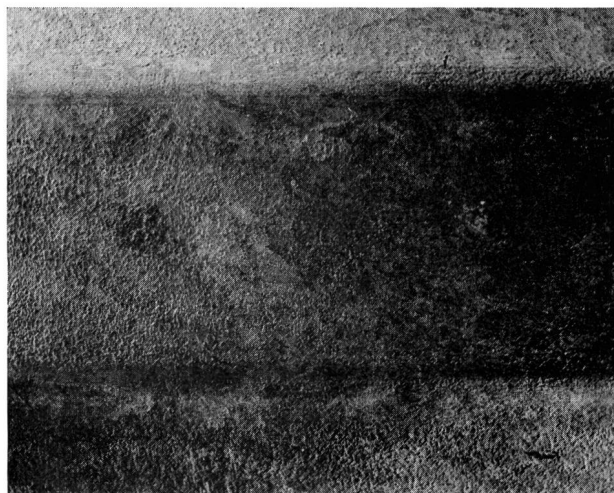
Fig. 9 Kanaltyp Nr. 9: Dicker Zinküberzug mit grübeliger Oberfläche
