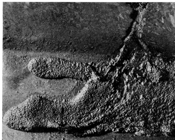
Fig. 5 Kanaltyp Nr. 8: Starke Zinkansammlung am Kanalende, vermutlich durch vorzeitiges Abstellen der Abblasluft entstanden
