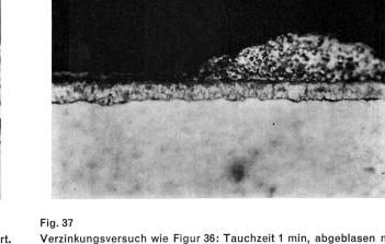
Verzinkungsversuch wie Figur 36: Tauchzeit 1 min, abgeblasen mit
