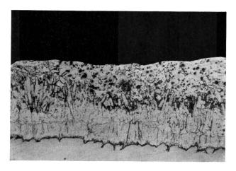
Fig. 40 Verzinkungsversuch: Kanaltyp Nr 4, Verzinkerei A, Stahl 33 siliciert (von Roll 0,08 % C  $\pm$  0,19 % Si). Normale Struktur der ersten Angriffsart
