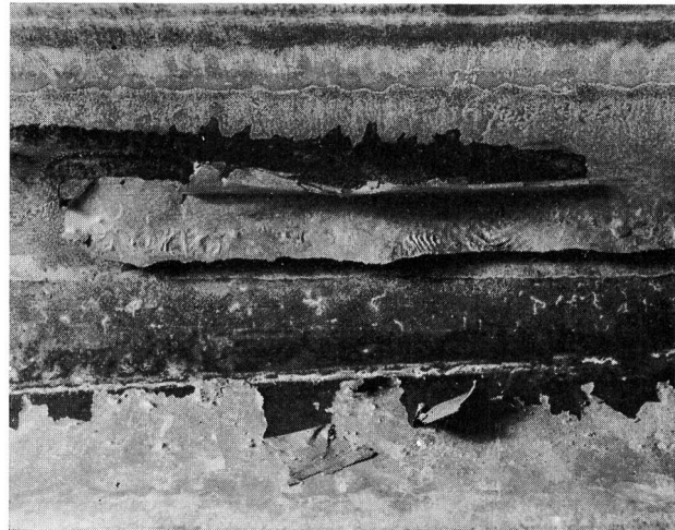
Fig. 2 Kanaltyp Nr. 4: Unter der abblätternen Zinkschicht kommt die samtige, dunkel erscheinende Legierungsschicht zum Vorschein
