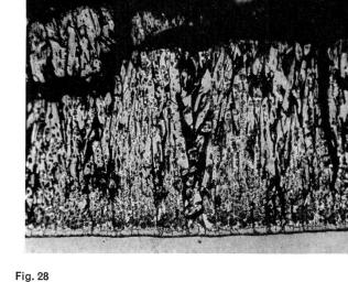
Verzinkerei C, Kanaltyp Nr. 8: Querschnitt durch einen grauen, porigen, über 300 μm starken Überzug, der absplittert. Die ursprünglich die Legierungskristalle umgebende Zinkschmelze ist unter Bildung von ζ-Kristallen vollständig aufgebraucht worden
