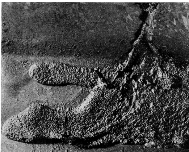
Fig. 5 Kanaltyp Nr. 8: Starke Zinkansammlung am Kanalende, vermutlich durch vorzeitiges Abstellen der Abblasluft entstanden
