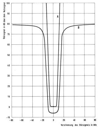
Fig. 8 HF-Selektion des Empfängers A Ein-Signal-Selektivität B Zwei-Signal-Selektivität
