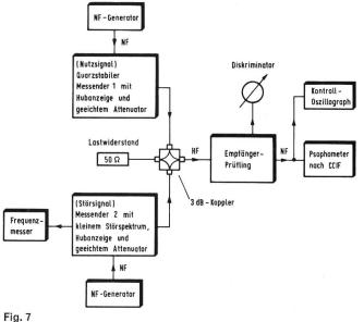
Messanordnung für die Empfängerprüfung (Selektivität, Intermodulationsstörung)
