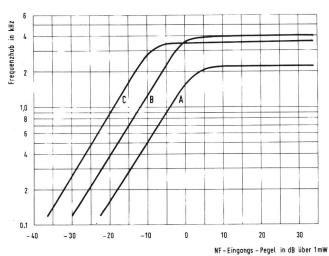
Fig. 2 Modulatoraussteuerung Modulationsfrequenz A = 0,4 kHz B = 1,0 kHz C = 3,0 kHz
