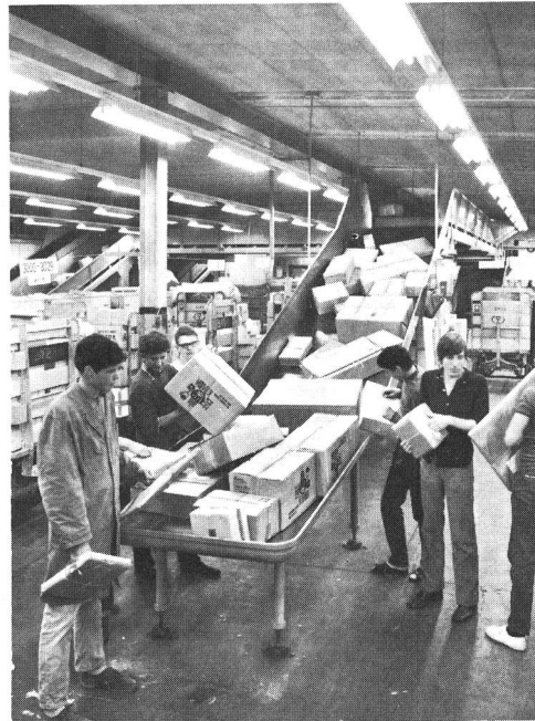
Fig. 6 Feinsortieren der Pakete an der Rutsche 1 Tri de détail des colis à la glissoire 1
