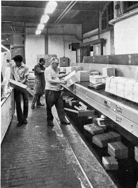
Fig. 2 Arbeitsplatz bei der Vorsortierstelle. Entladen der Paketkarren und Vorsortieren der Pakete nach zwei Richtungen auf Förderbänder Place de tri préliminaire. Déchargement des colis et tri préliminaire selon deux directions, à l'aide de rubans transporteurs
