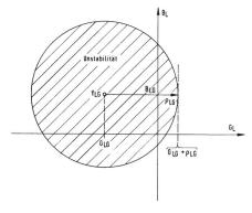
Fig. 4 Stabilität und Unstabilität dargestellt in der Ebene der Lastadmittanz  $Y_L = G_L + j B_L$
