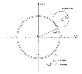
Stabilitätskreis nach *Bodway* in der r<sub>L</sub>-Ebene für Transistor 2 N 3570 bei 800 MHz in Emitterschaltung. Das «unstabile» Gebiet im passiven Bereich ist schraffiert
