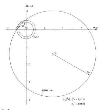
Stabilitätskreis nach *Bodway* in der r<sub>G</sub>-Ebene für Transistor 2 N 3570 bei 800 MHz in Emitterschaltung. Das «unstabile» Gebiet im passiven Bereich ist schraffiert
