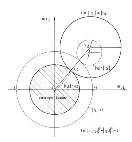
Fig. 1 Im Fall I ist das Innere der Kreise (c<sub>LG</sub>,  $\varrho_{LG}$ ) unstabil. Für  $|r_G| < |r_{GK}|$  liegen diese Kreise ausserhalb des Einheitskreises  $|r_L| = 1$
