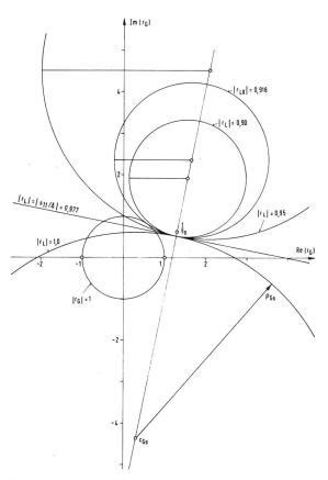
Fig. 3 Kreise (c<sub>GL</sub>,  $\varrho_{GL}$ ) in der  $r_G$ -Ebene für den Transistor 2 N 3570 (I $_C=5$  mA, U $_{CE}=6$  V) bei 100 MHz in Emitterschaltung. Der Übergang von Fall II:  $s_{11}{}^2-|r_L{}^2|^2<0$  zu Fall II:  $|s_{11}|^2-|r_L{}^2|^2>0$  tritt für  $|r_L|=|s_{11}/{}^2|=0,977$  ein, während  $|r_{LK}|=0,918$  beträgt
