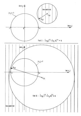
Fig. 9 Zur Ableitung des kritischen Wertes  $|r_{GK}|$  von  $|r_G|$ ; Fälle I und II
