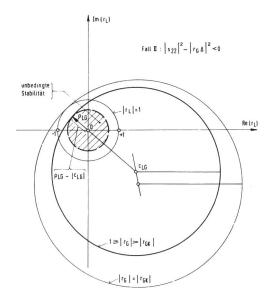
Fig. 2 Im Fall II ist das Innere der Kreise (c<sub>LG</sub>,  $\varrho_{LG}$ ) stabil. Für  $|r_{G}| < |r_{GK}|$  liegt der Einheitskreis gänzlich innerhalb dieser Kreise
