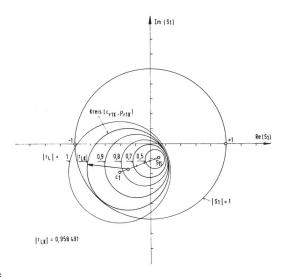
Fig. 5 Eingangs-Reflexionsfaktor  $S_1$  in der  $S_1$ -Ebene für den Transistor 2 N 3570 in Emitterschaltung bei 800 MHz mit den Daten gemäss Abschnitt 3, für verschiedene Beträge $|r_L|$  des Last-Reflexionsfaktors
