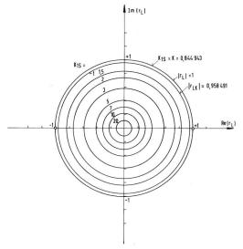
Fig. 8 Kreise von konstantem Stabilitätsfaktor  $\rm K_{1S}$  in der  $\rm r_L$ -Ebene für Transistor 2 N 3570 bei 800 MHz in Emitterschaltung
