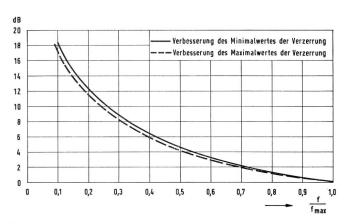
Fig. 5 Verbesserung des Störabstandes in Funktion der Frequenz bezüglich der Maximalfrequenz
