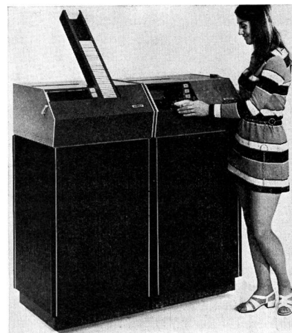
Fig. 1 Schnellkopieranlage für Videobänder
