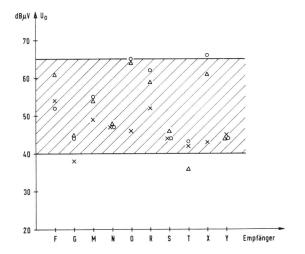
Fig. 21 Oszillatorspannung an den UHF-Eingangsklemmen gemessen an  $\rm Z_0 = 60~\Omega$
