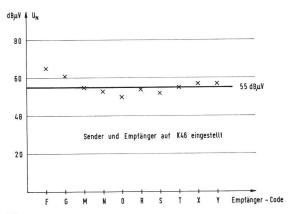
Fig. 10b Normaler Empfang (Empfindlichkeit) Eingangsspannung für Rauschqualität 1–2 (PTT-Testbild)
