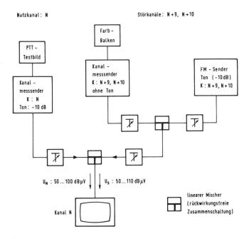
Fig. 6 Versuchsaufbau zur Messung der Spiegelstörung
