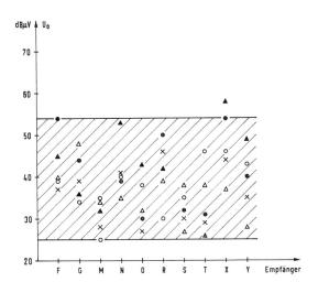
Fig. 22 Oszillator-Oberwellen an den VHF-Eingangsklemmen gemessen an Z $_{\rm O}=60~\Omega$
