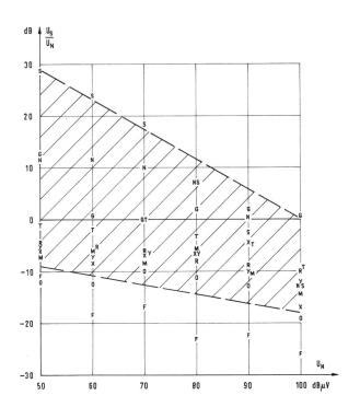
Fig. 7 Spiegelstörung, Signalabstand  $\frac{U_s}{U_N}$  für Sichtbarkeitsgrenze  $U_N$  Nutzkanal N= Kanal 45
