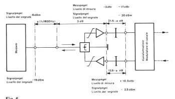
Pegelplan für Datenübertragung auf Mietleitungen mit Trägerkanal Diagramma dei livelli per la trasmissione di dati su linee in locazione con canali a correnti portanti
