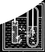
Natrium-Schwefel-Zelle der Firma Ford. Die Na-Ionen ( ) wandern durch die Keramik. Die Elektronen ( ) wandern über die negative
