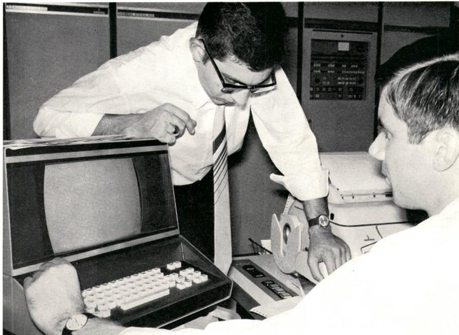
Ähnliche Endgeräte werden als Kommunikationsmittel mit dem Computer im TERCO-System eingesetzt
