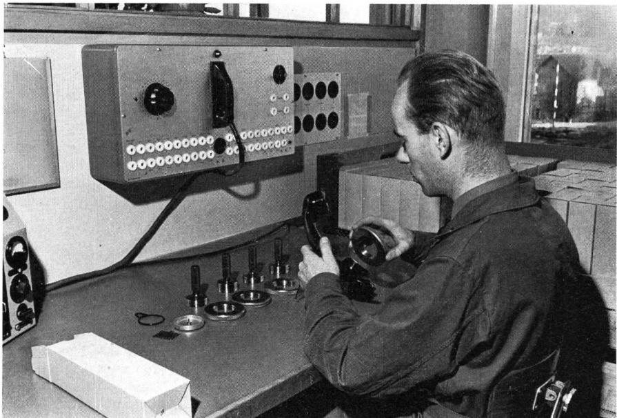
Auch das Mikrotelephon wird einer genauen Abnahmeprüfung unterzogen
