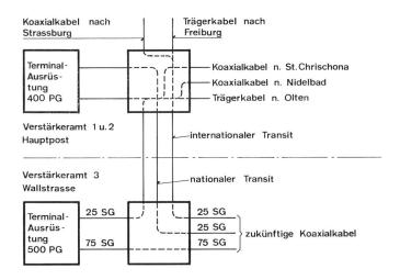
Fig. 14 Schaltdiagramm der Sekundärgruppen
