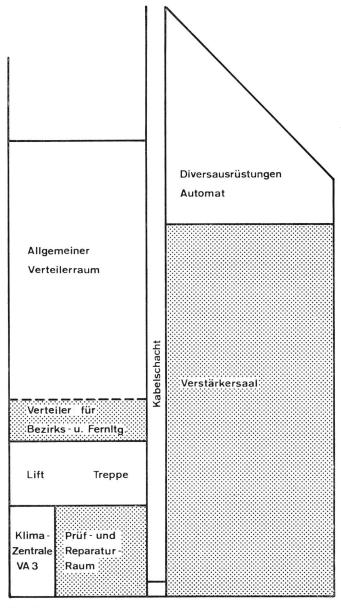
Fig. 13 Die schraffierte Fläche stellt den für das neue Verstärkeramt zur Verfügung gestellten Platz dar
