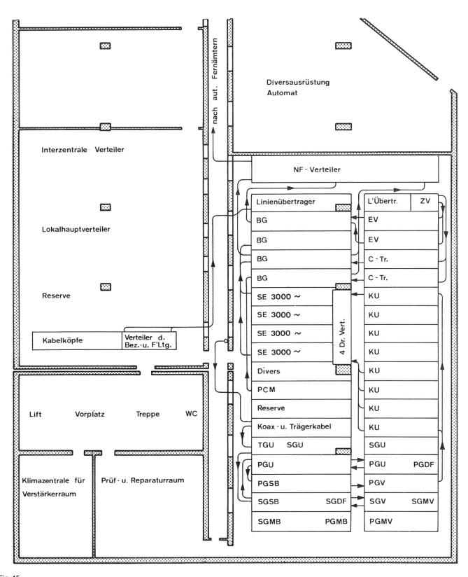
Fig. 15 Erstgeplante Aufstellung der Ausrüstungen (Erläuterungen s. Fig. 16)
