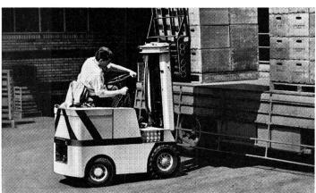
Auf Hunderten von Elektrofahrzeugen und Hubstaplern beweisen Electrona-Dural Batterien täglich ihre Überlegenheit. Electrona-Dural ist die einzige Doppelröhrchenplatten-Batterie. Ihre Vorteile: Bis zu 20% mehr Kapazität als bei traditionellen Gitterplatten-Batterien, bedeutend längere Lebensdauer und weniger Wartungs-
