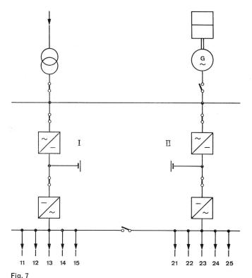
Wie Figur 2, jedoch Ersatz der rotierenden Maschinen durch statisch arbeitende Gleich- und Wechselrichter
